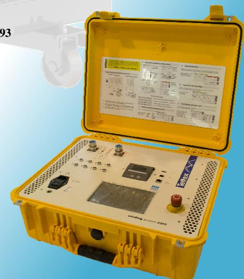
Analizator namotaja Tettex 2293 pri ispitivanju energetskih transformatora služi za:
